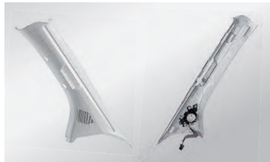
A-Säulenverkleidung (Vorder- und Rückansicht)
